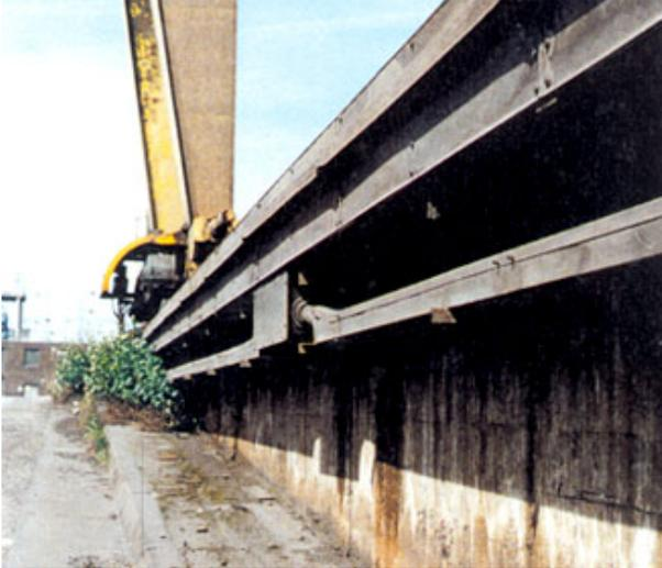
Pueden suministrarse en III + T + N polos o multiconductores, en caja de PVC, acero pintado o galvanizado, aluminio o acero inoxidable.
